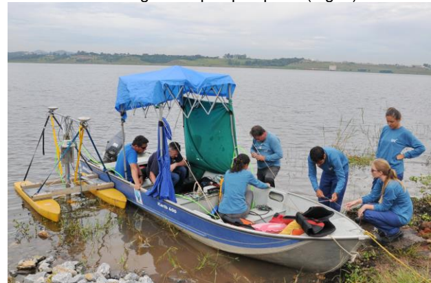
Figura 3: Sonar de Varredura lateral Interferométrico Edgetech modelo 6205 instalado em catamarã acoplado a embarcação de pequeno porte. Levantamento de reservatório nos arredores da cidade de São Paulo.
